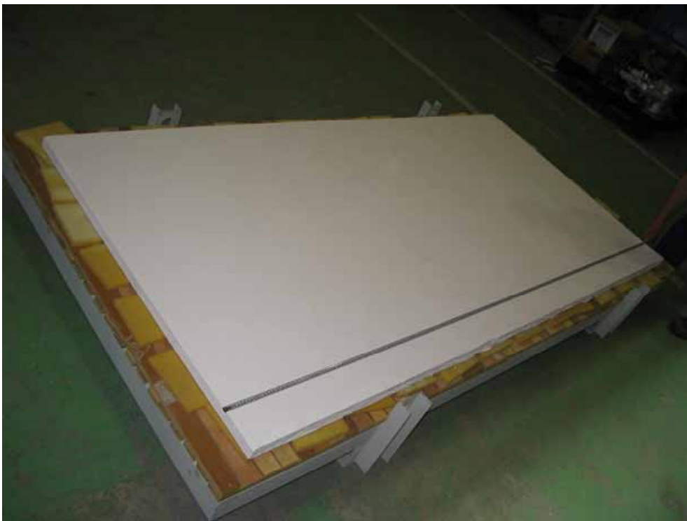
(写真3) 成形体例 3200mm × 1200mm × 50mm
